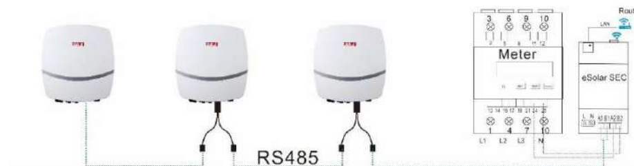
Figura 2: Divisor de cable Ethernet y conexión de cable
